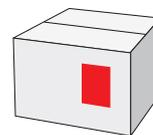
Utilisé essentiellement pour l'étiquetage de produits unitaires, de boîtes et de conditionnements extérieurs dont les surfaces latérales sont droites et planes.
